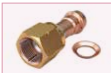
Manicotto con terminale in Acciaio Inox con dado girevole SAE45 in ottone e cartella in rame da 1/4" x 1/4" a 3/4" x 3/4"
