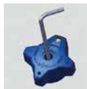
C) Quitar el tapón verde del mando. Usando una llave Allen de 4mm girar el dispositivo de memoria en el sentido del reloj hasta el tope, la posición de apertura máxima está fijada en 2.5 vueltas.
