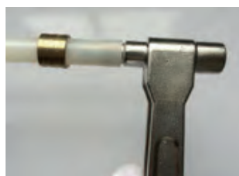
2. Elargir le tube avec l'outil évaseur
