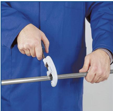
Rohre sind vorzugsweise mit einem Rohrschneider, alternativ mit feinzahnigen Bügelsägen oder speziellen elektrischen Rohrsägen rechtwinklig abzulängen.
