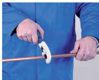
1. Corte de tubo 1. Cortar o tubo
